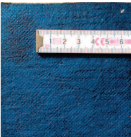
Obr. 06 Příklady horní povrchové úpravy asfaltových pásů. A - hrubozrnný minerální posyp, B - jemnozrnný minerální posyp, C – geotextilie z polyesterového rouna, Zdroj: [vlastní].
