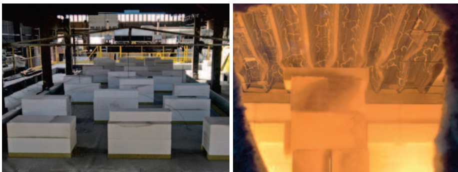
Obr. G 03, 04 Fotografie zkoušky požární odolnosti (příprava zkoušky a její průběh). Zdroj: [vlastní].
