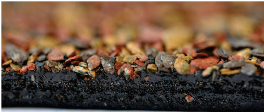
Obr. 05 Řez asfaltovým pásem pro použití jako vrchní vrstva hydroizolačních souvrství střeš. Na horním povrchu asfaltové krycí vrstvy hrubozrnný minerální posyp. V řezu je zřetelná nosná vložka. Zdroj: [vlastní].
