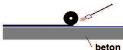
Obr. D 08 Směrování plamene při natavování na betonu (vlevo) a EPS (vpravo). Zdroj: [vlastní].
