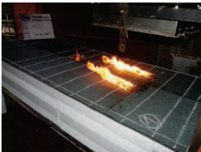
Obr. G 02 Fotografie zkoušky chování při vnějším požáru B_{ROOF}(t3) (hořící hranička, sálavé teplo, ventilátor). Zdroj: [vlastní].
