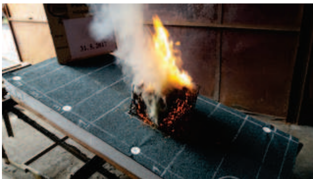
Obr. G 01 Fotografie zkoušky chování při vnějším požáru B_{\text{ROOF}}(t_1) (hořící hranička). Zdroj: [vlastní].
