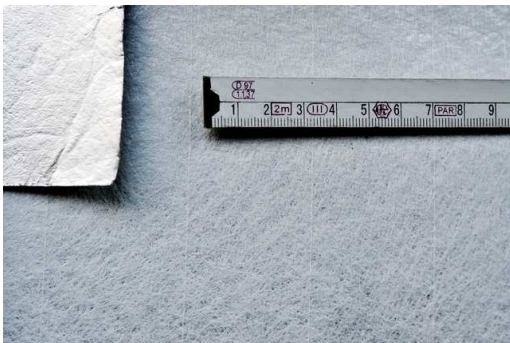
Obr. 12 Detail vložky s AI fólií vyztužené skleněnou rohoží. Zdroj: [vlastní].
