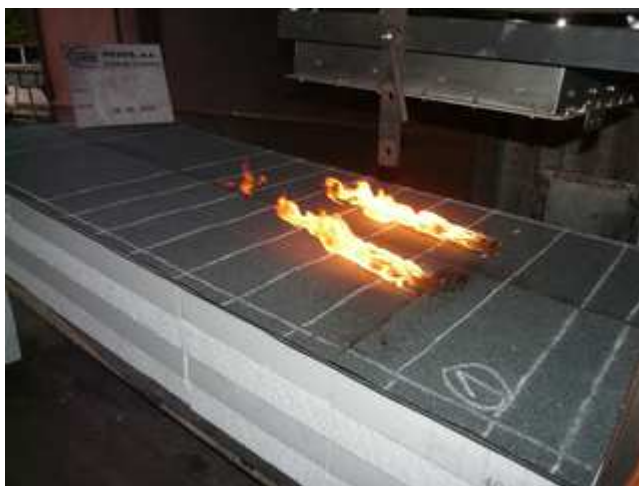
Obr. G 02 Fotografie zkoušky chování při vnějším požáru B_{ROOF}(t3) (hořící hranička, sálavé teplo, ventilátor). Zdroj: [vlastní].
