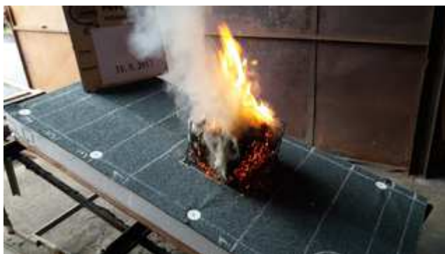
Obr. G 01 Fotografie zkoušky chování při vnějším požáru B_{ROOF}(t1) (hořící hranička). Zdroj: [vlastní].
