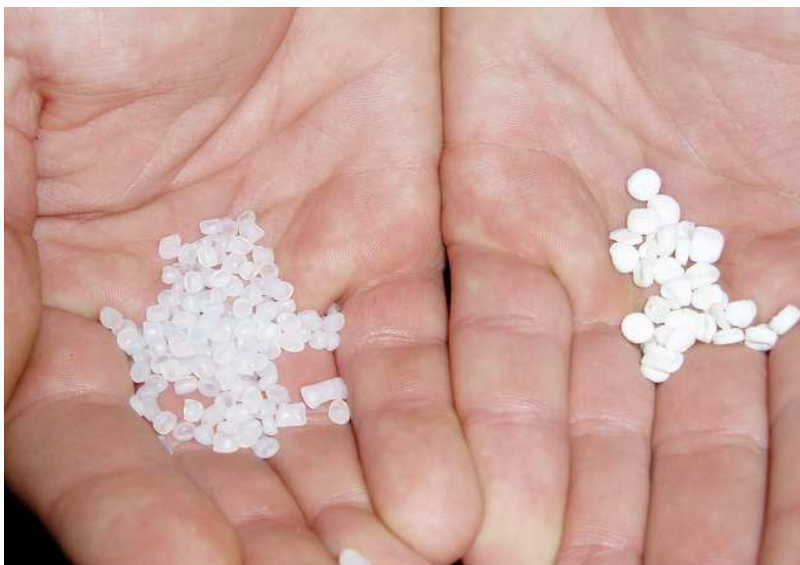
Obr. 08 Vlevo granulát APP modifikátoru, vpravo SBS modifikátor. Zdroj: [vlastní].
